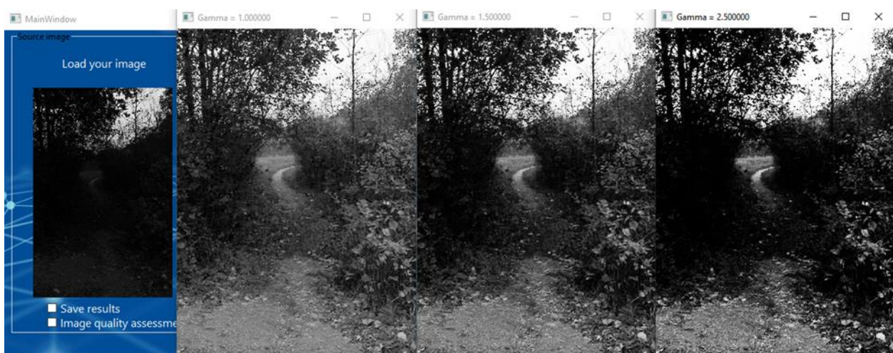
Рис. 4. Результат работы гамма метода при различных значениях параметра \gamma
