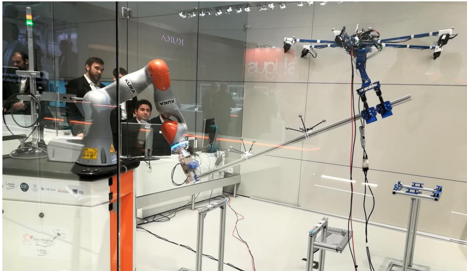
Рис. 28. Моментальный снимок состояния совместной манипуляции Tele-MAGMaS с использованием подхода двустороннего дистанционного управления, выполненного во время премии KUKA 2017 Innovation Award на Ганноверской ярмарке
