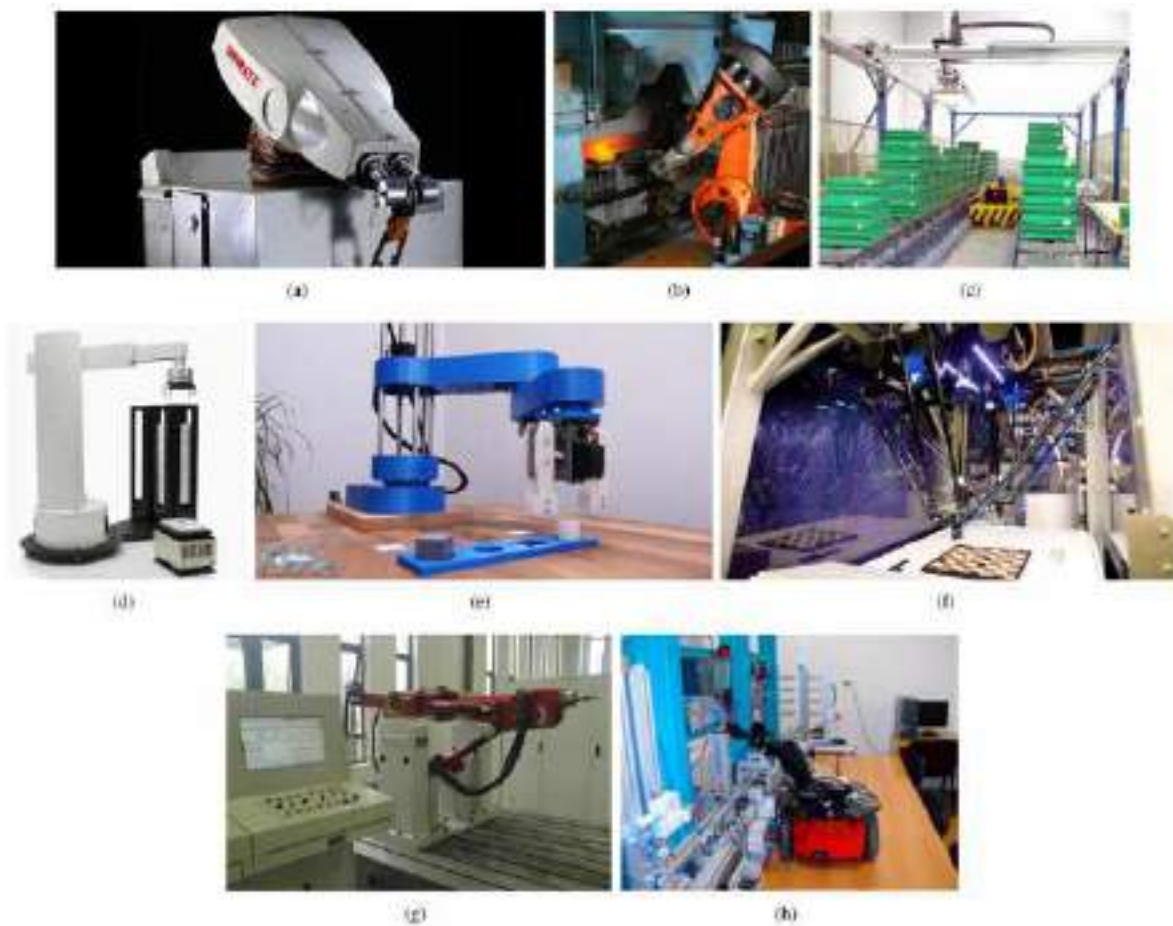
Рис. 11. Примеры промышленных роботов с приложениями в RAD: (а) робот Unimate с полярной конфигурацией, (б) шарнирный робот в литейном цехе, (в) порталный робот, (г) Настольный цилиндрический робот-манипулятор микроплашетов для автоматизации лаборатории, (е) робот-манипулятор для сборки с селективным соответствием, (ф) дельта-робот Codian Robotics, (г) прототип робота TriMule®, (h) Колесный мобильный робот на сборочно-разборной линии мехатроники
