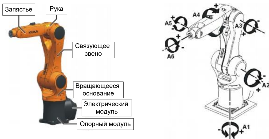
Рис. 2. Общий вид и схема степеней свободы ПР Кука KR 6 R700 SIXX
