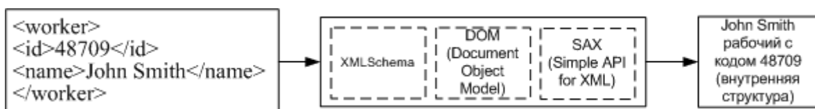
Рис. 6. Схема преобразования текстовых данных во внутренние форматы
