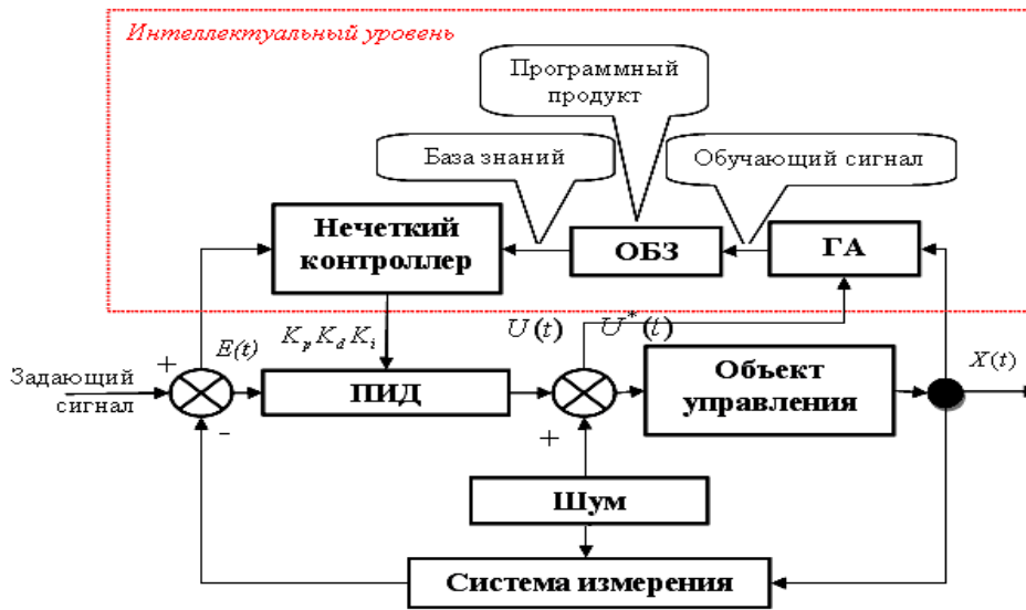
Рис. 1. Структура ИСУ с нечетким регулятором и оптимизатором баз знаний
