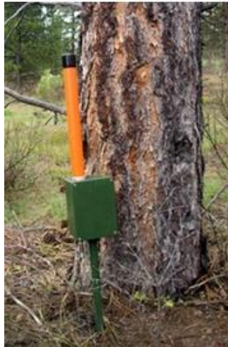
Рис. 1. Аппаратура на основе питания из растения американской компании «Votreepower», 2009 г.
