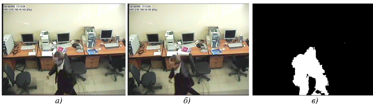
Рис. 1. Пример работы разностного алгоритма: а) и б) соседние изображения; в) их разность после пороговой обработки
