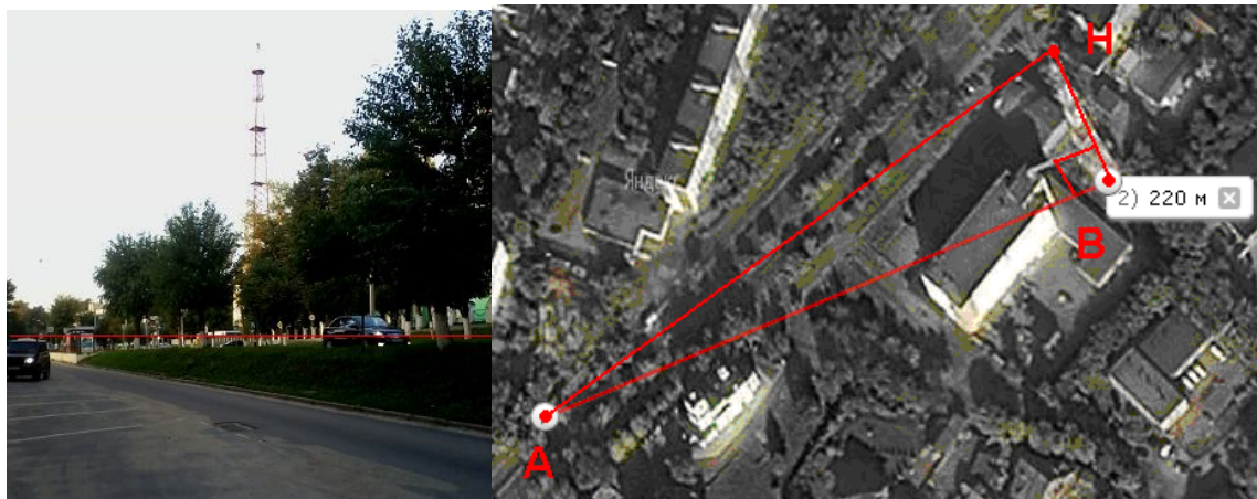
Рис. 2. Определение высоты телекоммуникационной мачты
