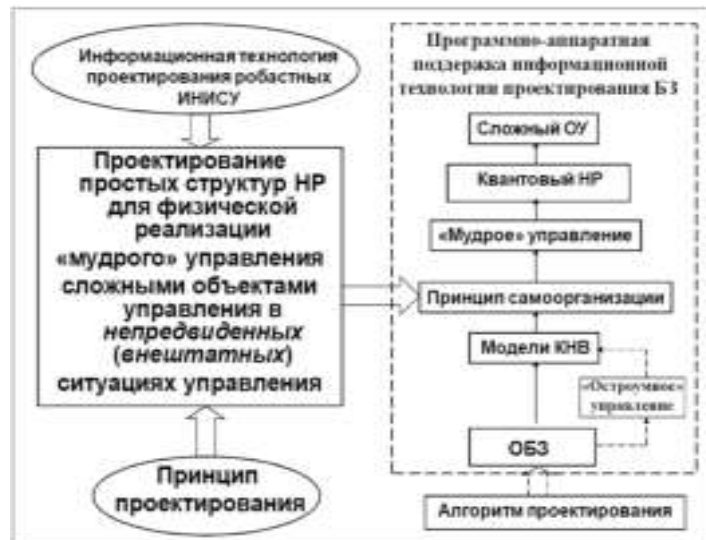
Рис. 2. Блок-схема логической взаимосвязи принципов и этапов информационной технологии проектирования робастных БЗ
