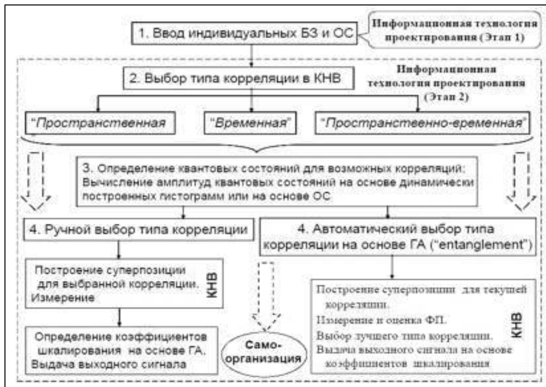
Рис. 4. Блок-схема проектирования робастных БЗ и структура информационных потоков в технологии проектирования робастных БЗ на основе принципа самоорганизации ИСУ
