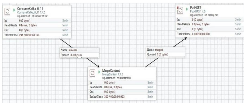
Рис. 9. Объединение файлов и их сохранение в HDFS с помощью NiFi
