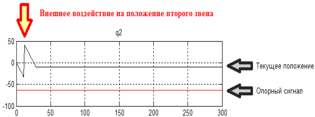
Рис. 7. Моделирование внешнего воздействия на второе звено манипулятора
