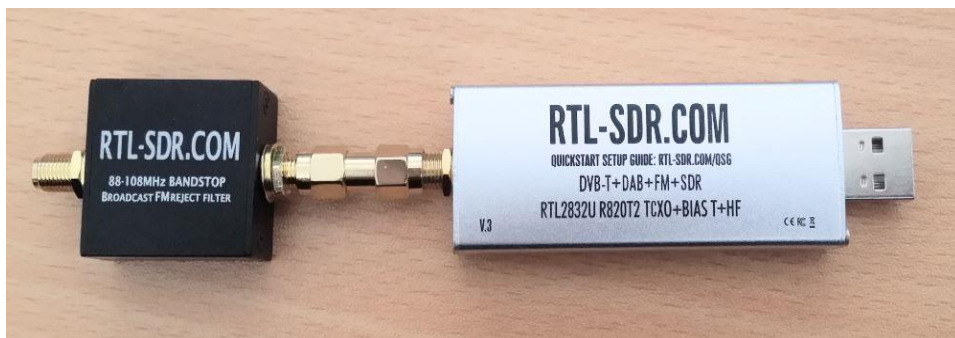
Рис. 4. RTL-SDR приемник с фильтром
